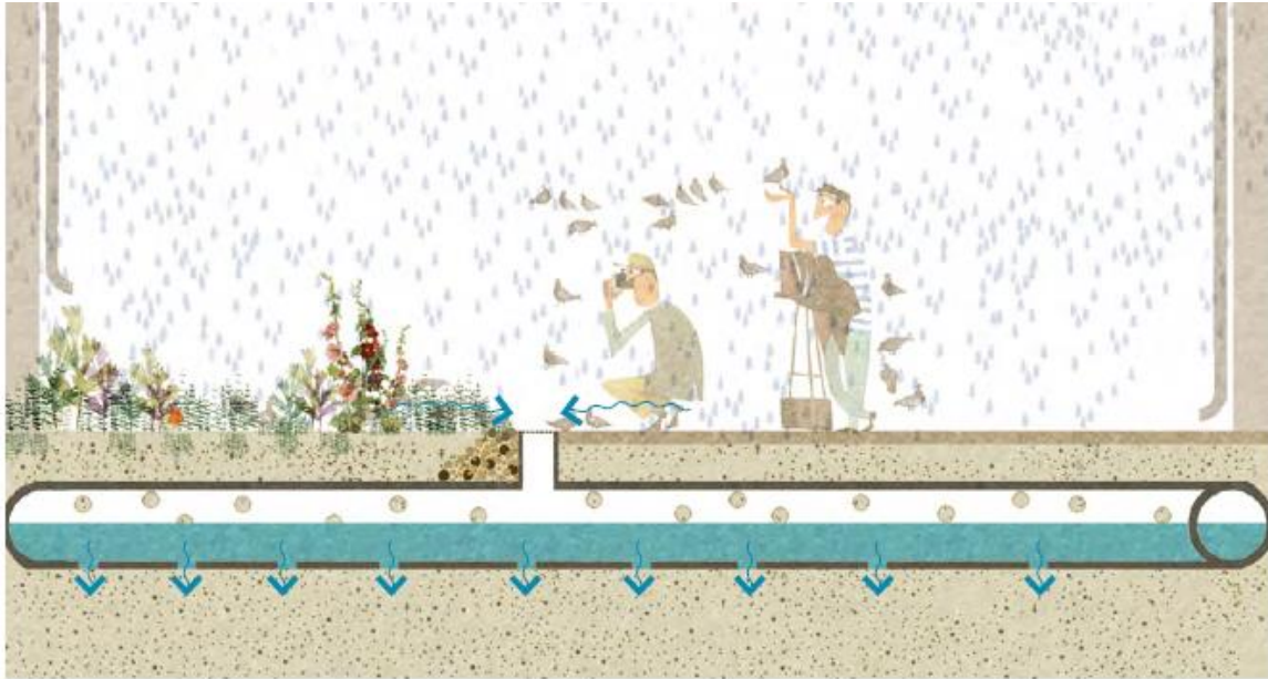
Afbeelding 4.4 Voorbeeld van een geperforeerde hemelwaterriolering
